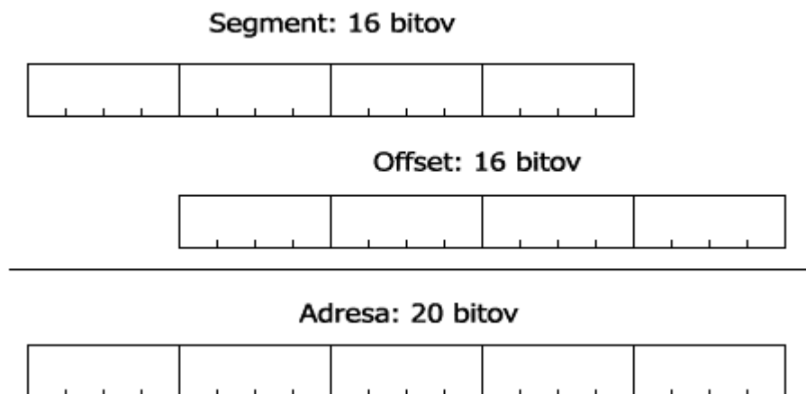
Obr. 1 – Výpočet fyzickej adresy procesorom 8086
